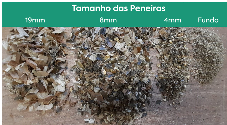
Figura 10. Amostra de silagem de milho separada conforme tamanho de partícula pela Penn State Box
