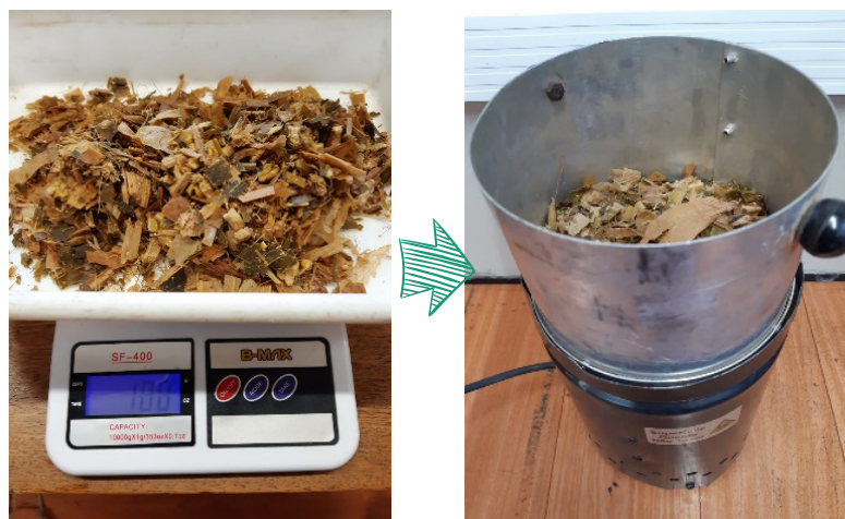
Figura 5. Estimativa de matéria seca utilizando o Koster
