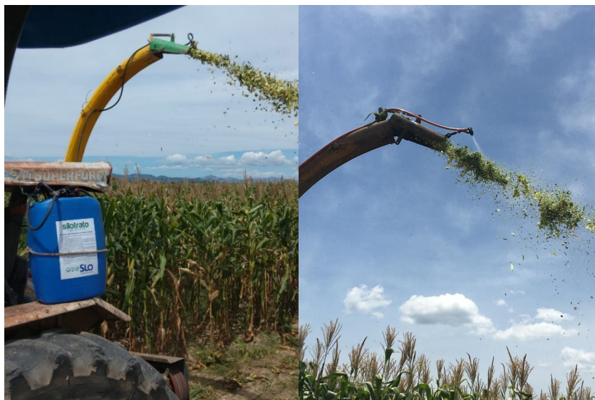
Figura 17. Máquina de aplicação de inoculante adaptada a ensiladeira
