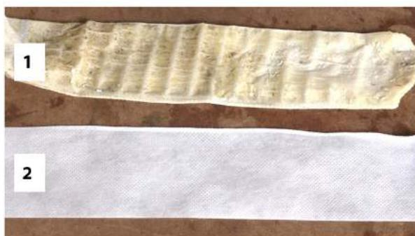
Figura 15 – Imagem 1: filtro com presença de grumos e imagem .2: filtro novo
