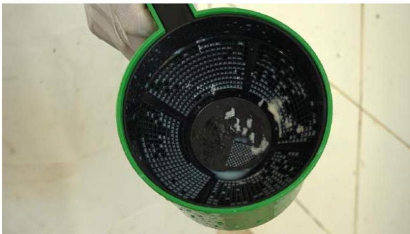
Figura 5 - Presença de grumos ao centro da caneca após o descarte dos 3 primeiros jatos
