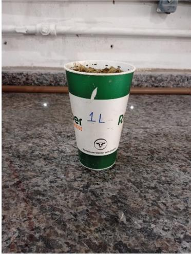
Figura 14 - Amostrar 1 litro do material picado
